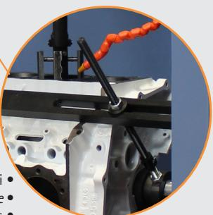
Supporto universale fissaggio cilindri •
