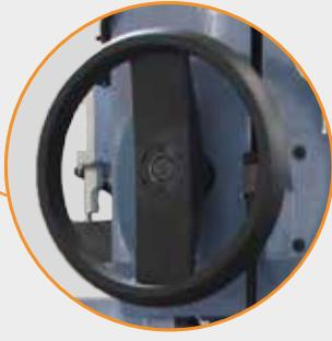
Finecorsa regolabile per una precisa e costante profondità di lavoro dell'utensile
