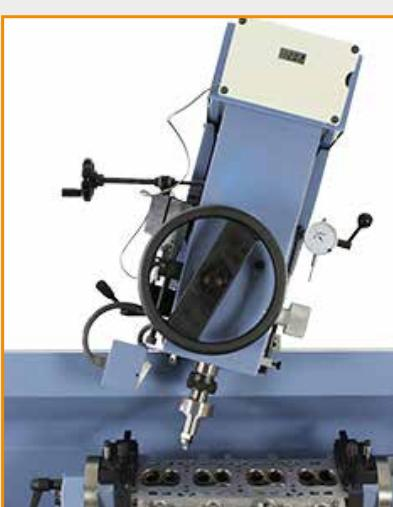
Inclinazione verticale dell'asse della testa di  $\pm 10^\circ$  in entrambe le direzioni per assicurare un allineamento preciso del mandrino sulle sedi inclinate delle testate.
