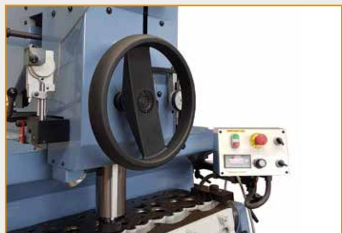
Doppio sistema di avanzamento mandrino: ampio volantino frontale per un preciso e rapido spostamento del mandrino e pomello laterale per un avanzamento micrometrico.
