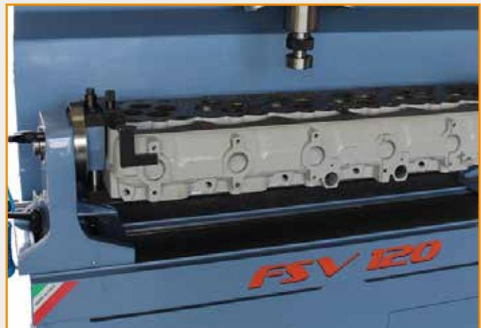
Supporto testate girevole a 360° per una completa accessibilità a tutti i punti della testata. Il sistema di staffaggio è molto rapido e offre elevata rigidità. Il livellamento è particolarmente semplice grazie al pomello di regolazione micrometrico.
