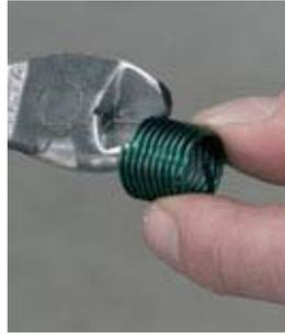
Se usa una tabla (ver descripción de la instalación) para seleccionar el HELICOIL® plus con el número adecuado de hilos "W". Si es necesario, con un alicate se puede seleccionar el número exacto de hilos.
