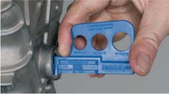
El calibre es utilizado para saber cuántos hilos necesita el HELICOIL® plus. En el ejemplo se ve que son necesarios 8,5 hilos para M 14 x 1.5.
