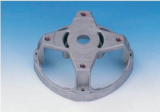
Disco de motor de una máquina de jardinería de aluminio. Seguridad contra el desenroscado con HELICOIL® plus screwlock M 8 x 12
