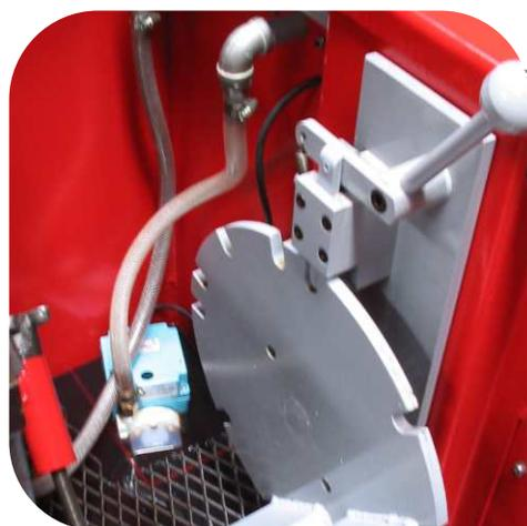
El accesorio de autocentrado de la PB - 2000 ha sido diseñado para hacer que el montaje del bloque sea fácil y seguro, cuenta con anclajes para motores en V a 30° y 45° permitiendo pulir un bloque en V en sus dos bancos de cilindros sin bajar el bloque de la maquina.
