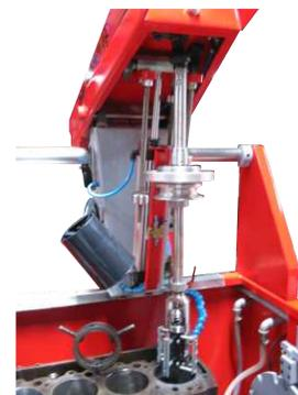
Los topes que determinan la longitud del cilindro se localizan convenientemente y hacen el proceso de pulido seguro y simple. El sistema de expansión de la piedras nos permite expandirlas y retraerlas de una forma sencilla y segura.
